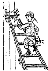
Phải từ hai cột thang vào điểm tựa, không từ bằng bậc thang
