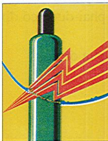
Không được để cho dây điện cọ sát vào bình
